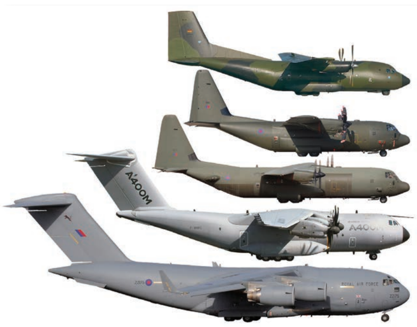
Comparaison de la taille des avions de transport militaire (de haut en bas) : Transall C 160 , Lockheed Martin C 130 J Super Hercules , C 130 J-30 Super Hercules , Airbus A 400 M , Boeing C 17 Globemaster III .
