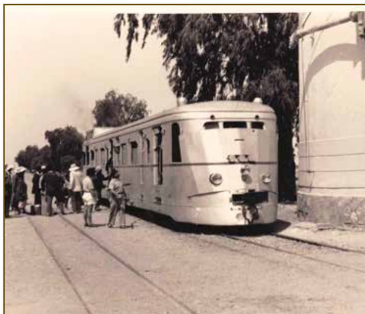
Exemple de blindage en Tunisie : en gare de Maknassy, un autorail diesel-électrique Brissonneau & Lotz de la SNCFT a reçu un blindage au niveau de la cabine.
