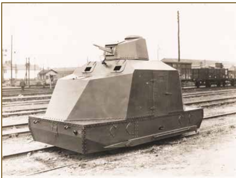
Draisine blindée Billard (à Tours), expérimentée mais non adoptée.
